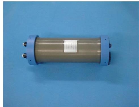
電子回路部  $\Phi$ 235×860 水中 7kg
